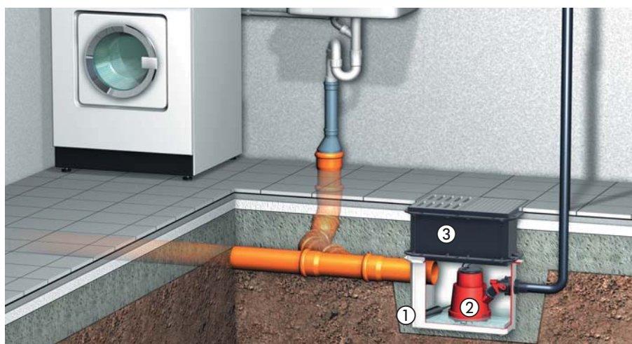
① Opvoerinstallatie ② Afvalwaterpomp ③ Verlengstuk (art.nr. 32 500)
